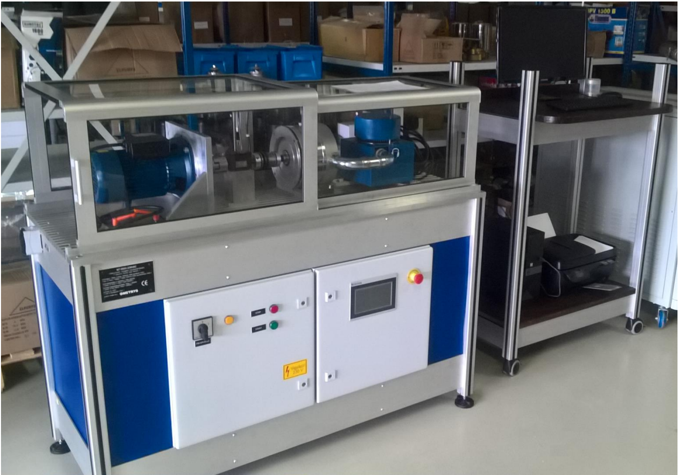
Prüfstand für Elektromotoren und die zugehörige Bedienstelle
